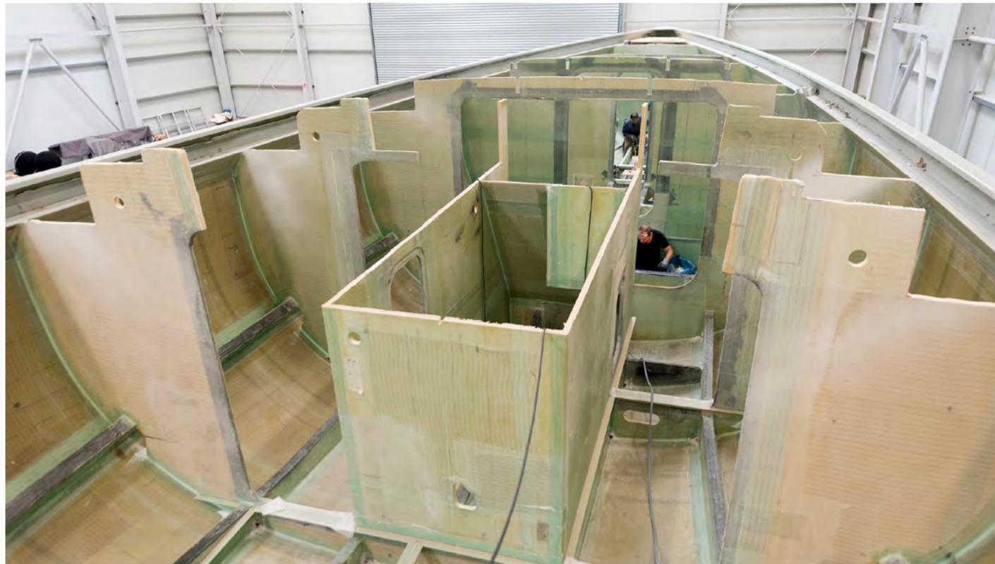
Der Rumpf des Forschungsschiffs «Eugen Seibold» ist fertig, nun geht es an den Innenausbau und die Installation der zahlreichen Messinstrumente.
