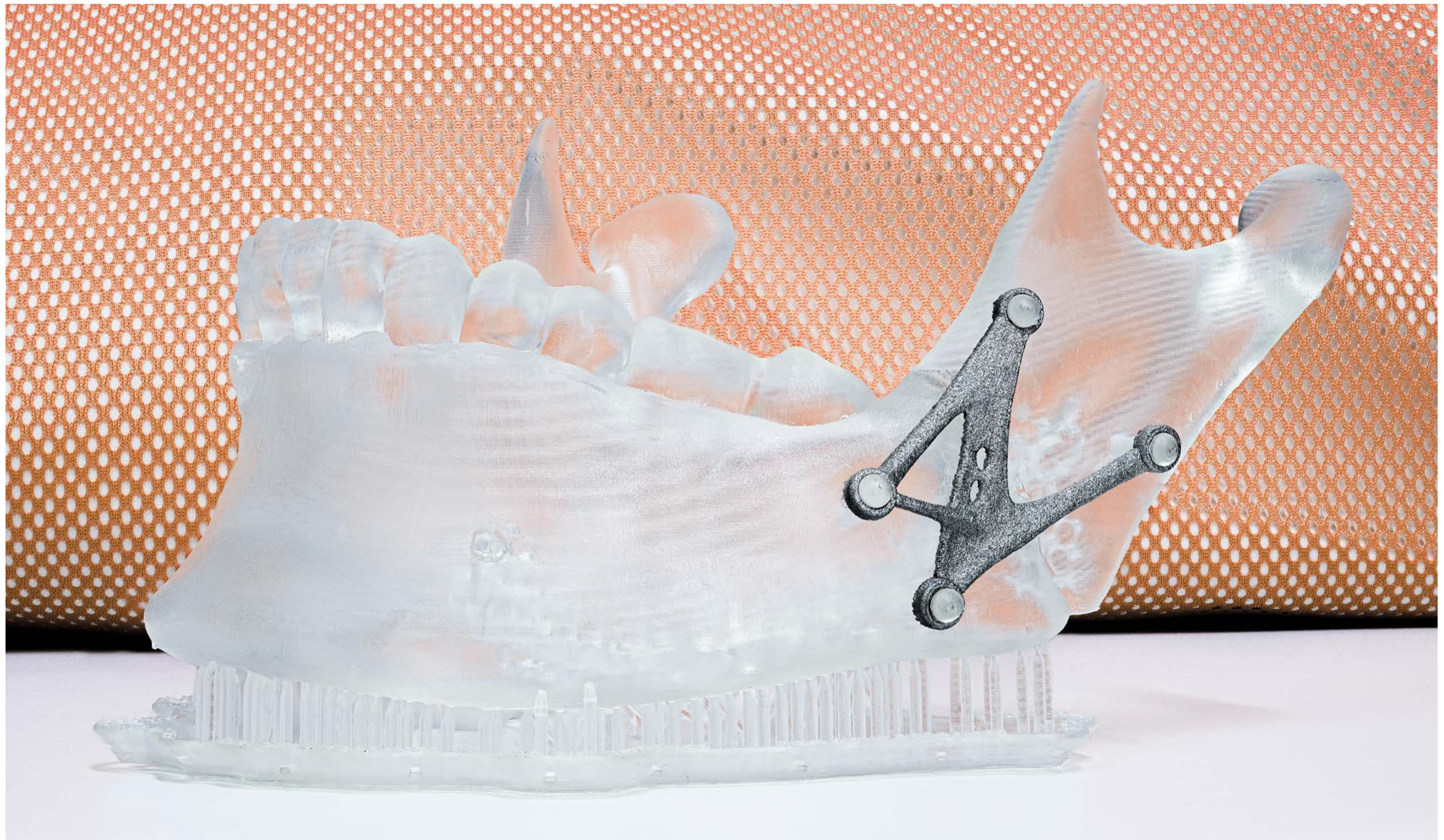
Mit Modellen und Implantaten aus dem 3D-Drucker verbessert das Projekt MIRACLE II Knochenoperationen.
