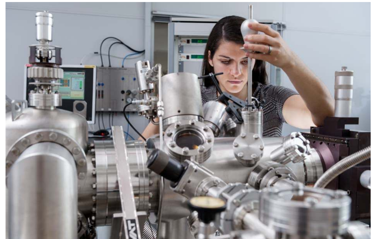
Die Materialingenieurin Dr. Gabriela Borin Barin vom CarboQuant-Team untersucht eine Probe von Kohlenstoff-Nanobändern im Rastertunnelmikroskop.
