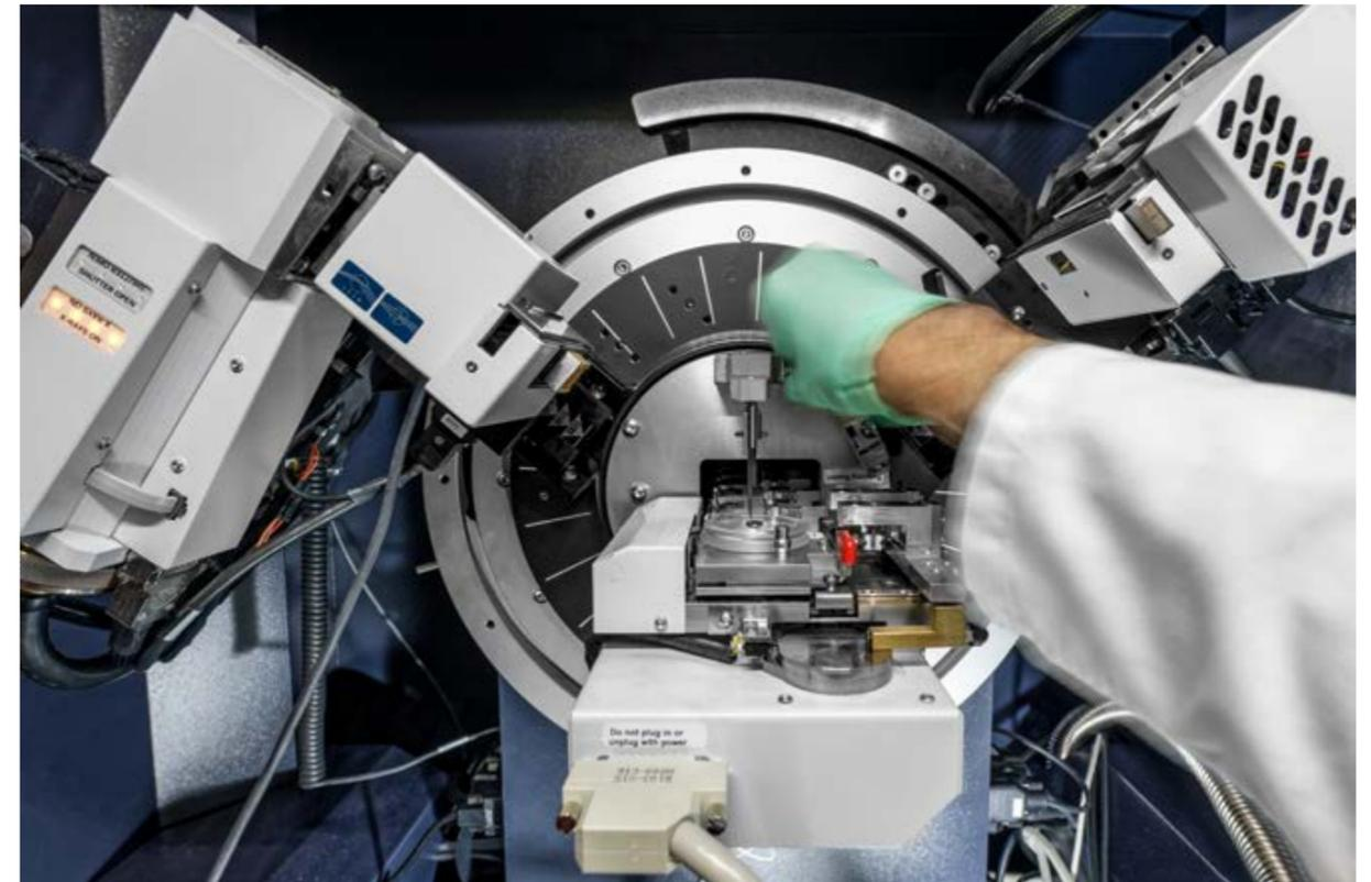
Die Struktur thermoelektrischer Materialkandidaten erkennen: Das Röntgen-Diffraktometer macht es möglich.
