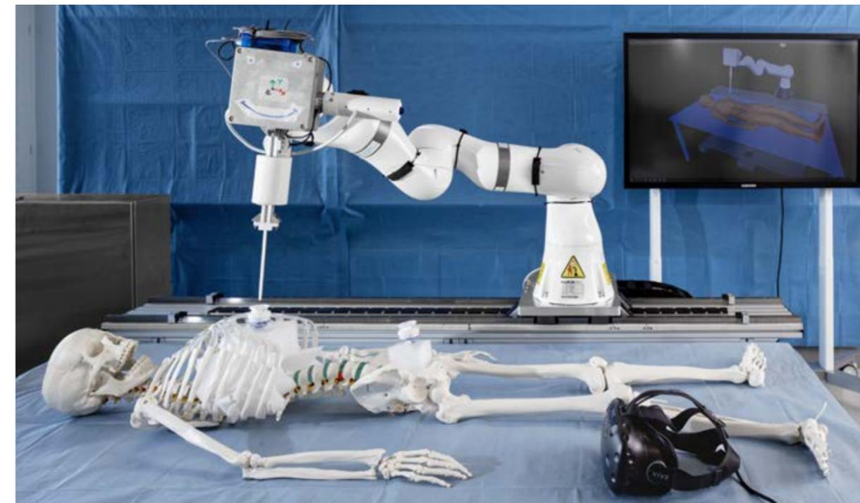
MIRACLE nimmt Gestalt an: Die wichtigsten Komponenten, die es für eine minimalinvasive, roboterunterstützte, computergesteuerte Knochenoperation mit Laser braucht, sind entwickelt.
