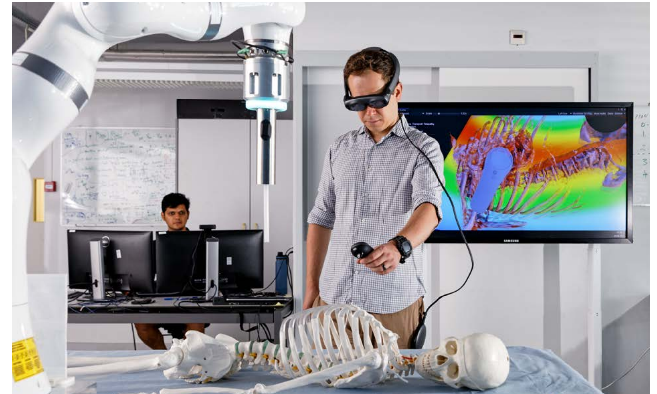
Die entwickelten Roboterkomponenten sind schon gut aufeinander eingespielt: Der «medizinische Joystick» erfasst die Stelle am Körper, die operiert werden soll, und der Operateur sieht in der Datenbrille und auf dem Bildschirm ein virtuelles 3D-Modell, das aus den Bildern der Computertomografie rekonstruiert wurde.
