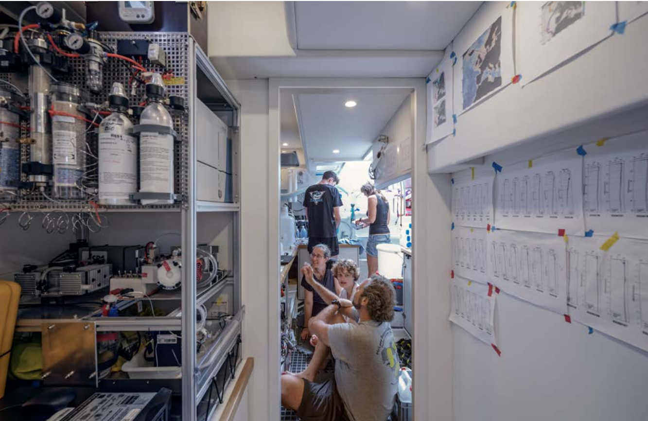
Der Platz auf der «Eugen Seibold» ist beschränkt, so wird auch der Boden genutzt. Auf dem Bild erklärt Meeres-Chemiker Hans Slagter (graues T-Shirt) den beiden Praktikantinnen die unter dem Labortisch installierte FerryBox, die die wichtigen physikalischen Umweltparameter Salz-, CO 2 - und Chlorophyll-Gehalt, pH-Wert und Temperatur misst. Im Vordergrund befindet sich das Trockenlabor mit den Massenspektrometern, die kontinuierlich den Umsatz von CO 2 und anderen Gasen in der obersten Schicht des Ozeans aufzeichnen.
