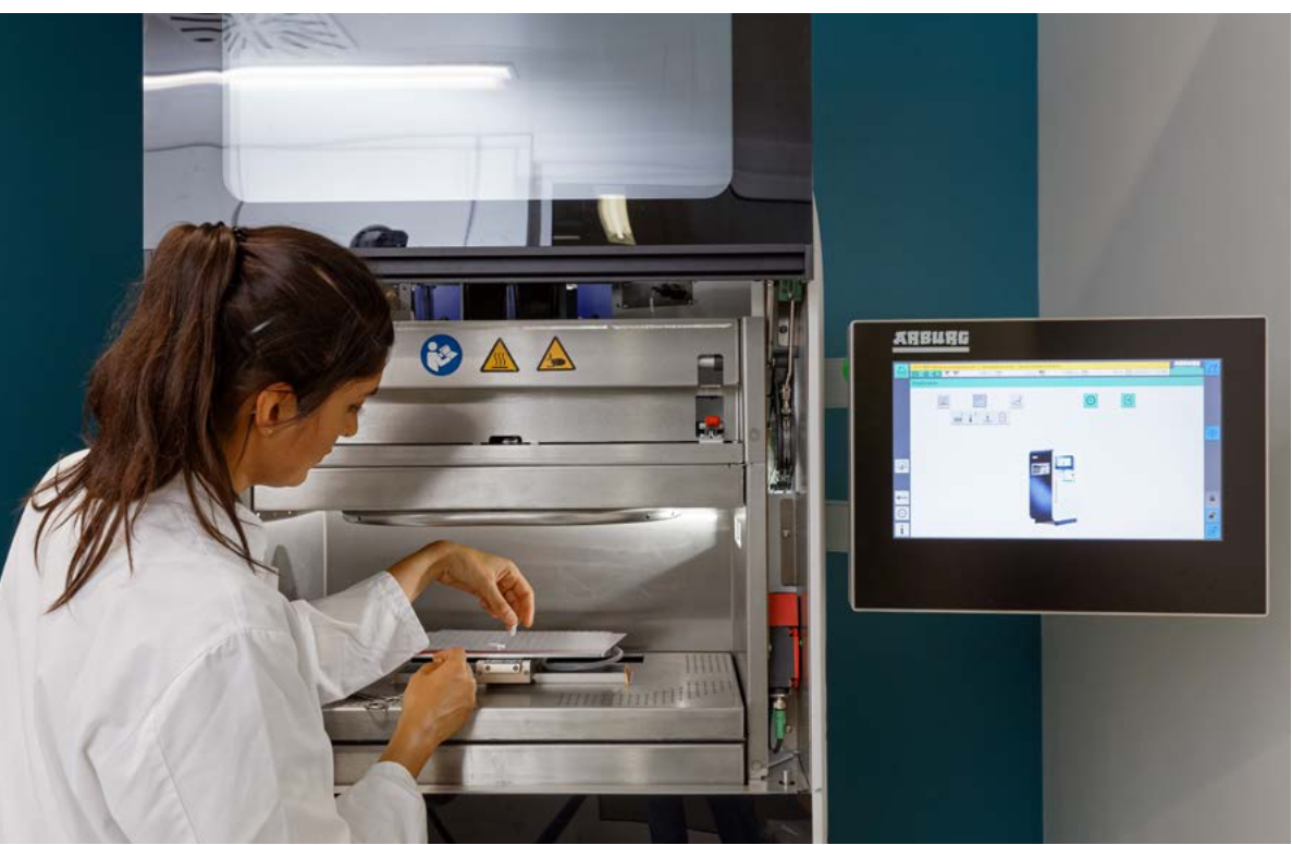
Mit dem neuen, grossen 3D-Drucker (in voller Grösse auf Seite 68 rechts im Bild zu sehen) lassen sich selbstauflösende Implantate und Knochenstrukturen herstellen.
